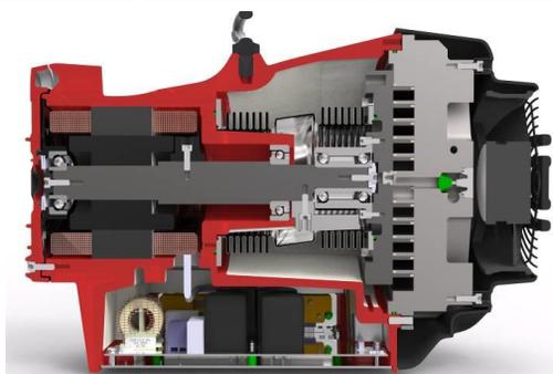
真空室と軸受け潤滑油が分離した完全クリーンなドライポンプです
